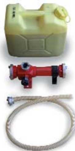
Schaummaterial Rohr und Beimischer müssen aufeinander abgestimmt sein.
