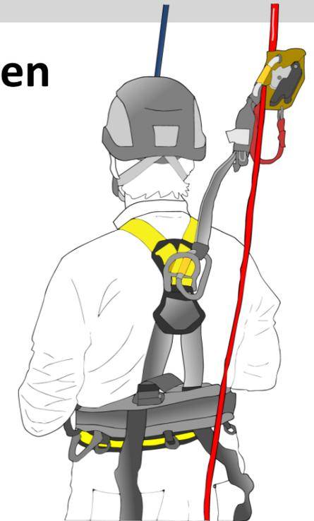
Mitlaufendes Auffanggerät mit Falldämpfer
