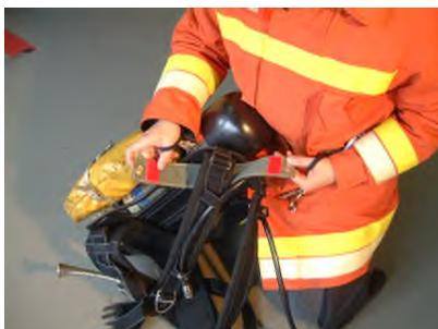
Den Bag-fix vor dem Einsatz montieren. Er wird am gegenüberliegenden Traggurt befestigt. \*
