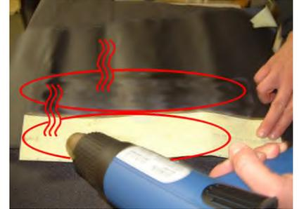
Reparaturkit und Restklebstoff erhitzen. Beide Stellen gleichmässig erhitzen bis der Klebstoff transparent ist.
