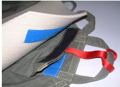
Sie wird zwischen der Unterlage und der Aussenhülle montiert. Die Hilfsschlinge sollte bereits an der Kopfschleufe montiert werden.
